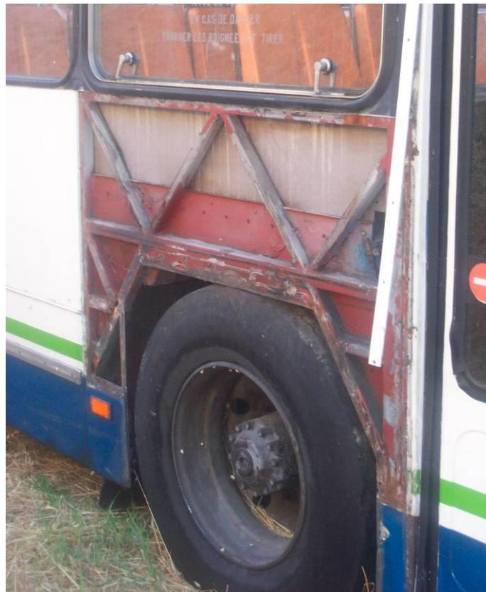
Les moteurs thermiques des trolleybus 201 et 213 fonctionnent aussi, mais la mauvaise nouvelle est que le 213 ne possède plus de compresseur ! Avec le risque qu'une tôle rentre dans une roue, par manque d'air des suspensions, détruisant le pneu, comme cela est arrivé sur le PR100 n°624 de TBFP.
