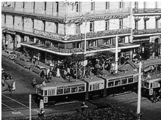
Ce prototype, mis à écartement spécial de 1,055 m et animé par 4 moteurs de 45 CV, est testé avec un tel succès à Alger, que les TA commandent 25 motrices, qui seront livrées en 1937.
