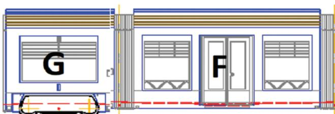
Il s'agit de la rame N°5, suivi depuis peu de la N°2, qui passent de 32,5 mètres à 42,5 mètres de longueur, soit deux modules supplémentaires, un avec bogie moteur, l'autre de type « portique » équipé d'une porte de chaque côté.
