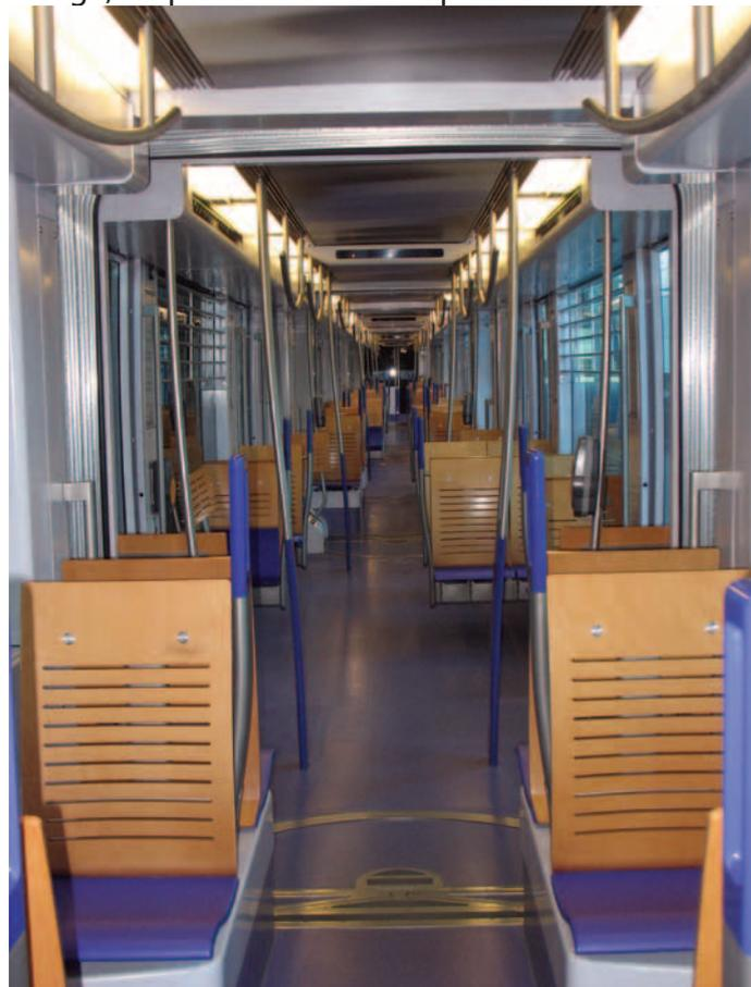
Au niveau de l'aménagement intérieur, on note une amélioration importante : l'installation de mains-courantes, ainsi que de colonnes de maintien. On a ainsi augmenté les moyens de préhension. La capacité passe de 42 à 62 places assises et de 158 à 199 places debout.
