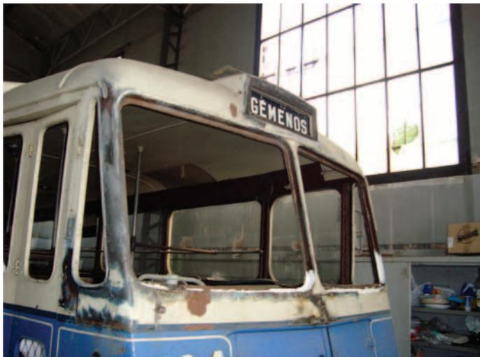
Le trolleybus BERLIET VETRA ELR 316 a vu sa face avant nettoyée de plus il a été calé afin qu'il soit présenté d'une façon plus horizontale. L'autobus BERLIET PBR a retrouvé son rétroviseur extérieur et les sièges qui étaient déchirés ont été remplacés.
