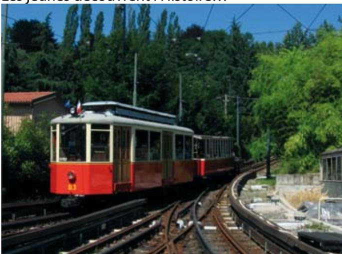
Aux limites permises à l'approche des rails de courant (600 V), nous assistons au départ d'un « tranvia a dentiera » (tramway à crémaillère) Sassi – Superga, qui remporte un vif succès en ce samedi estival. La vaillante motrice de 1932 pousse sa remorque de 1897.
